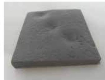
Il nastro in schiuma di PVC è assolutamente impermeabile, soffice e comprimibile. Per questa ragione si deforma facilmente sotto il peso della finestra favorendo il massimo contatto tra il nastro e la traversa inferiore del telaio e quindi l'impermeabilità all'acqua del sistema
